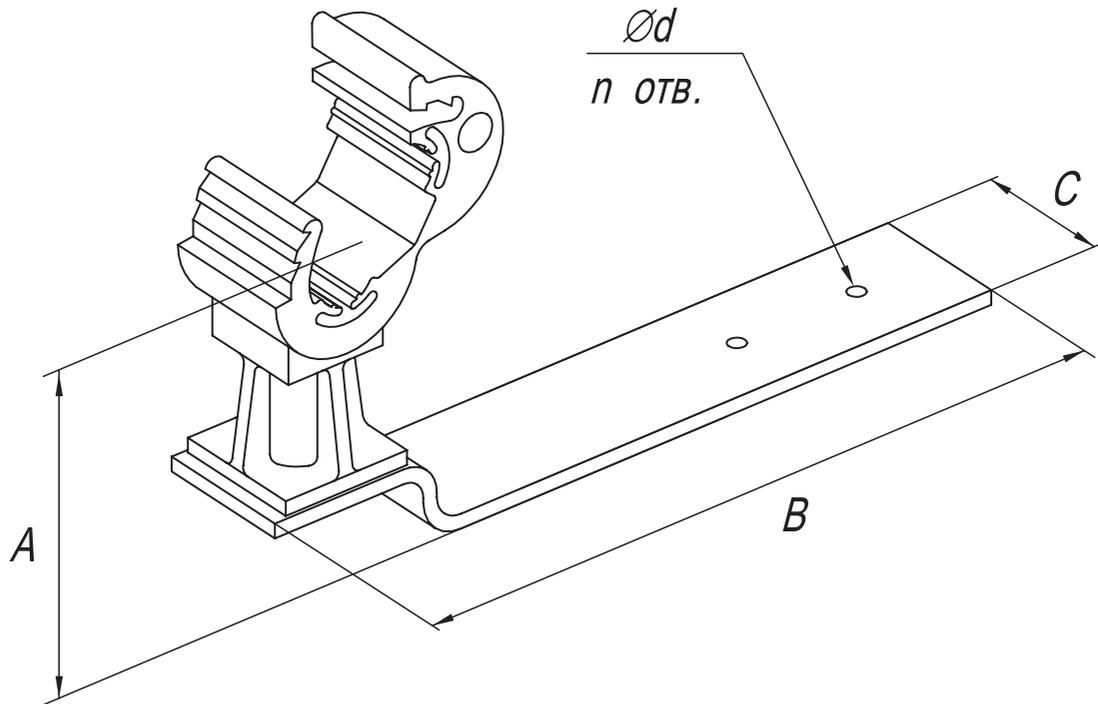
Держатель предназначен для фиксации токоотвода на черепичной кровле. Монтаж токоотвода осуществляется путем защелкивания держателя.
